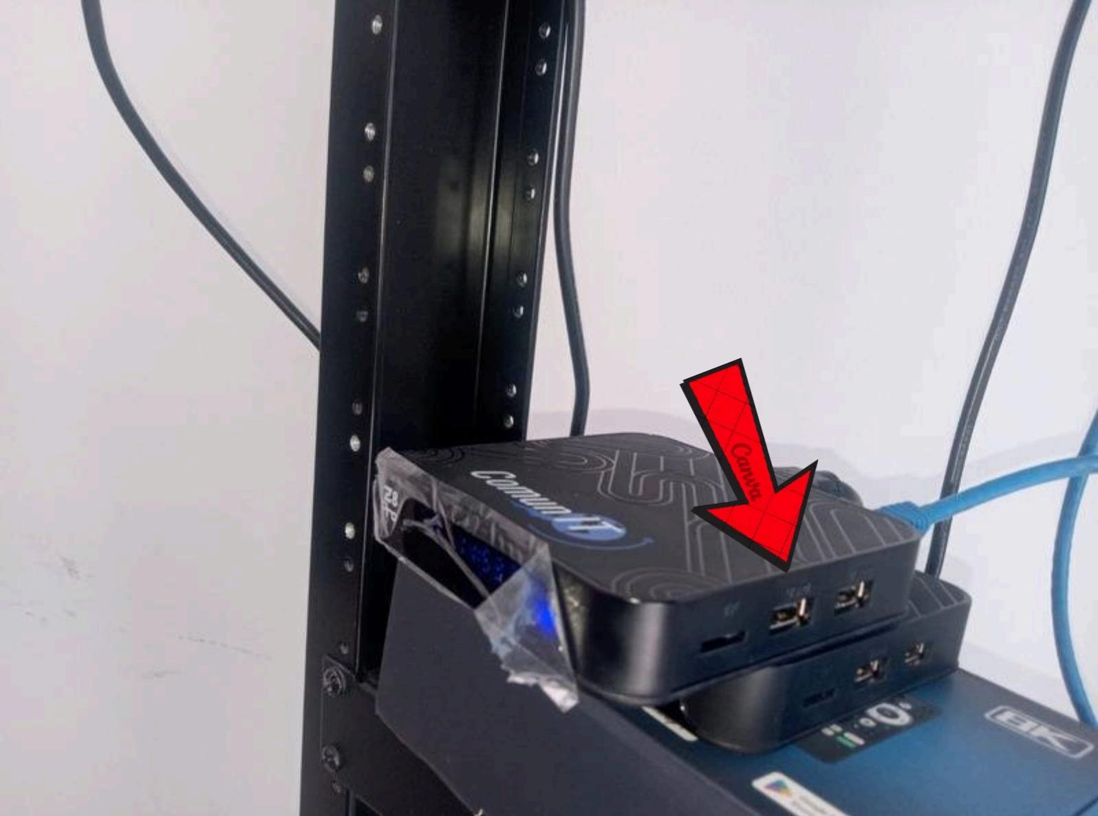
Las conexiones USB de un TV Box sirven principalmente para conectar dispositivos externos como memorias USB, teclados, ratones o controles. Estos puertos están diseñados para recibir datos o pequeñas cantidades de energía desde dispositivos pasivos. Es importante no conectar aparatos que generen corriente eléctrica, como cargadores u otros dispositivos que alimenten energía, ya que esto puede dañar el TV Box.
